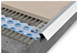
1.Scegliere "PROTERRACE ECO" in funzione dello spessore della piastrella.2.Tagliare "PROTERRACE ECO" alla lunghezza desiderata e fissarlo con i chiodi al supporto.3.Applicare il sistema impermeabilizzante desiderato avendo cura di sigillare il raccordo con il profilo.4.Posare la pavimentazione avendo cura di lasciare una fuga di circa 5 mm tra piastrella e profilo.5.Stuccare tra piastrella e profilo con PROBAND FIX.
